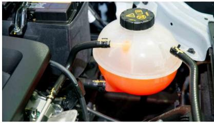
A l'image de l'huile moteur, le liquide de refroidissement joue un rôle fondamental dans le bon fonctionnement et la longévité du moteur. C'est un liquide qui n'est pas, en tout état de cause, fait pour durer éternellement. Au fil du temps et de l'utilisation du véhicule, sa qualité se dégrade et se répercute, hélas, sur l'efficacité du refroidissement du moteur.
