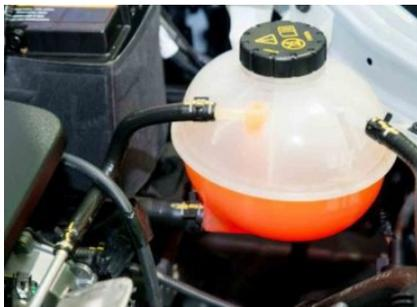
A l'image de l'huile moteur, le liquide de refroidissement joue un rôle fondamental dans le bon fonctionnement et la longévité du moteur. C'est un liquide qui n'est pas, en tout état de cause, fait pour durer éternellement. Au fil du temps et de l'utilisation du véhicule, sa qualité se dégrade et se répercute, hélas, sur l'efficacité du refroidissement du moteur
